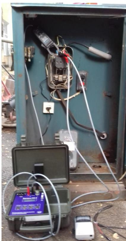
Рисунок 3.16 – Схема подключения «Баланс СК-2» к пульту управления УЭЦН
