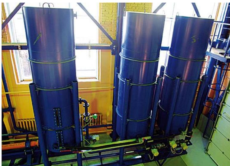
Рисунок 3.4 - Стенд ГЖС, блок подготовки рабочей жидкости
