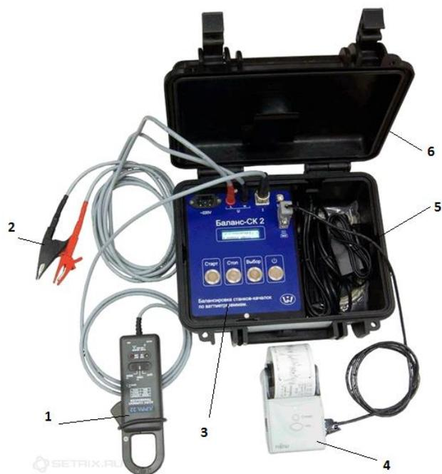
1 – токоизмерительные клещи; 2-зажимы «фазы» и «нейтрали»; 3 – прибор «Баланс СК -2» с графическим дисплеем и программным управлением; 4 – мобильный термопринтер; 5 – кабели; 6- переносной герметичный футляр
