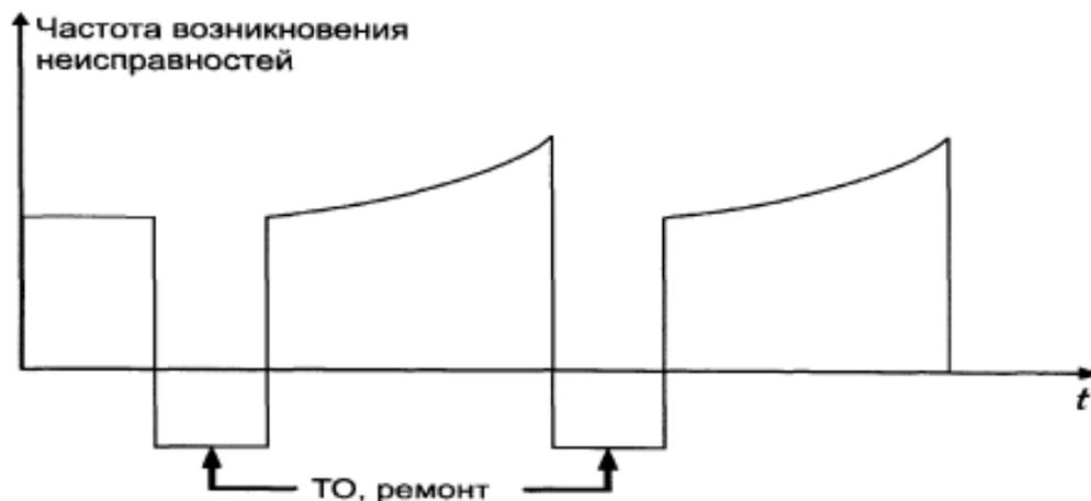
Рисунок 2.1 - Обслуживание на основе плановых ТО и ремонта (графика ПНР) УЭЦН
