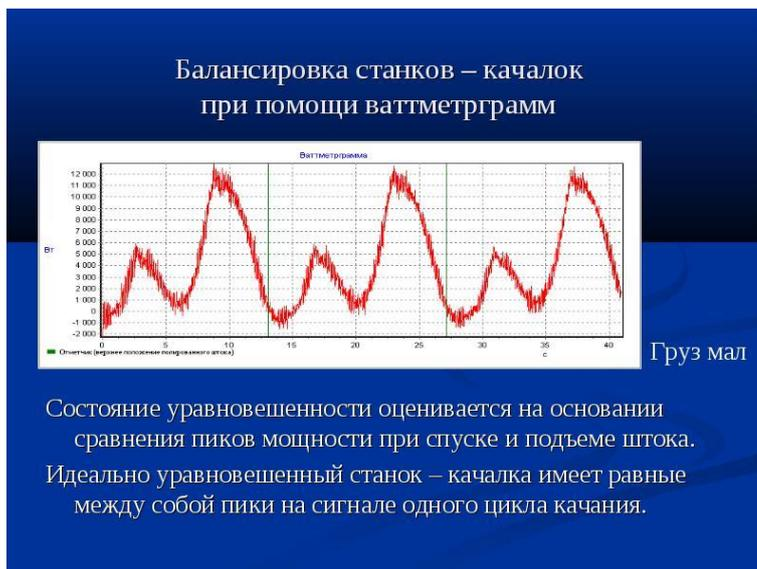
Рисунок 3.16 – Образцы ваттметрграмм
